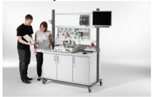
Курс тренирует практические навыки подключения, управления частотой вращения и торможения двигателей постоянного и переменного тока.
